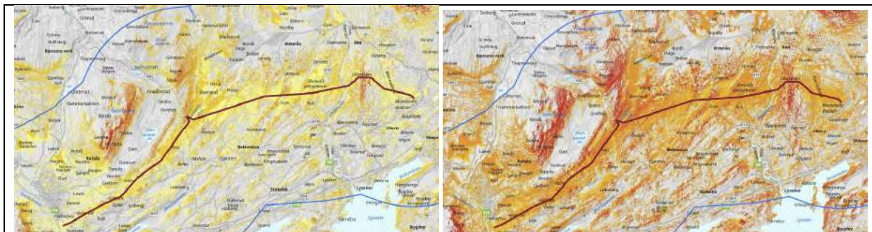
Utsnitt av synlighetskart som viser situasjon før og etter nytt luftspenn. (Kilde: Figur 5-45 og 5-46, s 52 KS vedlegg 10 «Konsekvensutredning Landskapsbildet» Rapport Sweco 2019.
