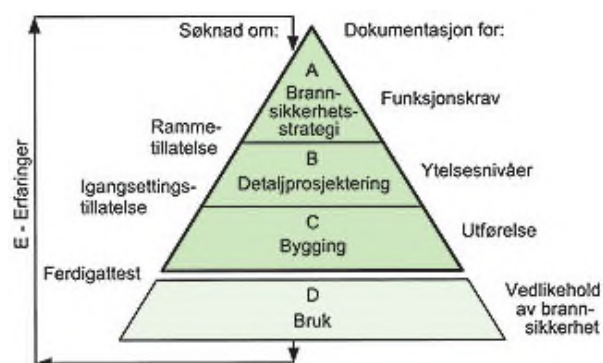
Figur 1. Nivåer for dokumentasjon av brannsikkerhet (NBI 321.026)
