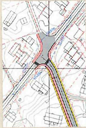
Skisse av løsning Gjønnesveien x Høvikveien. Merk at sykkelrute er tilpasset eksterierende fartsgrænse på 50km/t. Ved nedsetting av fartsgrænse til 40 km/t kan sykkelrute reduseres til 6x4,0m.
