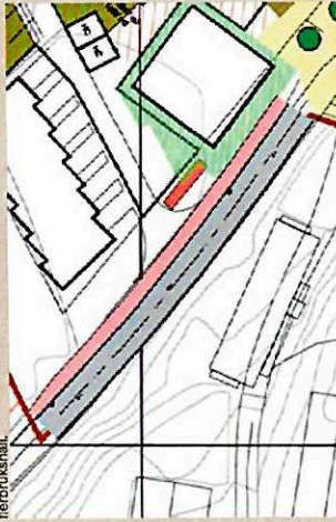
Skisse av løsning Gjønnesveien x Høvikveien. Merk at sykkelrute er tilpasset eksterierende fartsgrænse på 50km/t. Ved nedsetting av fartsgrænse til 40 km/t kan sykkelrute reduseres til 6x4,0m.
