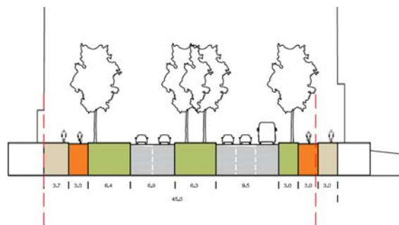
Snarøyveien nord/Fornebuporten – prinsipp for transformasjon - snitt
