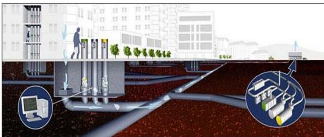
Vakumanlegg for innsamling av avfall på Fornebu. Via separate innkast for restavfall, plast og papir suges avfallet gjennom et rør fra boligområdene inn til mottaksentralene der avfallet komprimeres i containere og fraktes til gjenvinning eller destruksj. Vakumanlegg for innsamling av avfall på Fornebu (Kilde: www.itbaktuelt.no )
