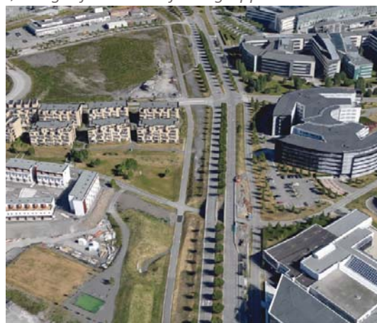
Snarøyveien: arealkrevende anlegg med planskilte løsninger for ulike trafikanter
