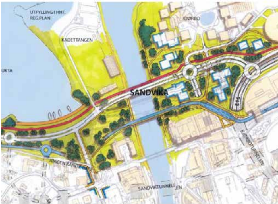
Utsnitt av optimalisert løsning Sandvika (SVV) – som viser vegsystemet på Kjørbo med firefelts lokalveg og bussgate, kryss med E16, ramper og firefelts samleveg/E16
