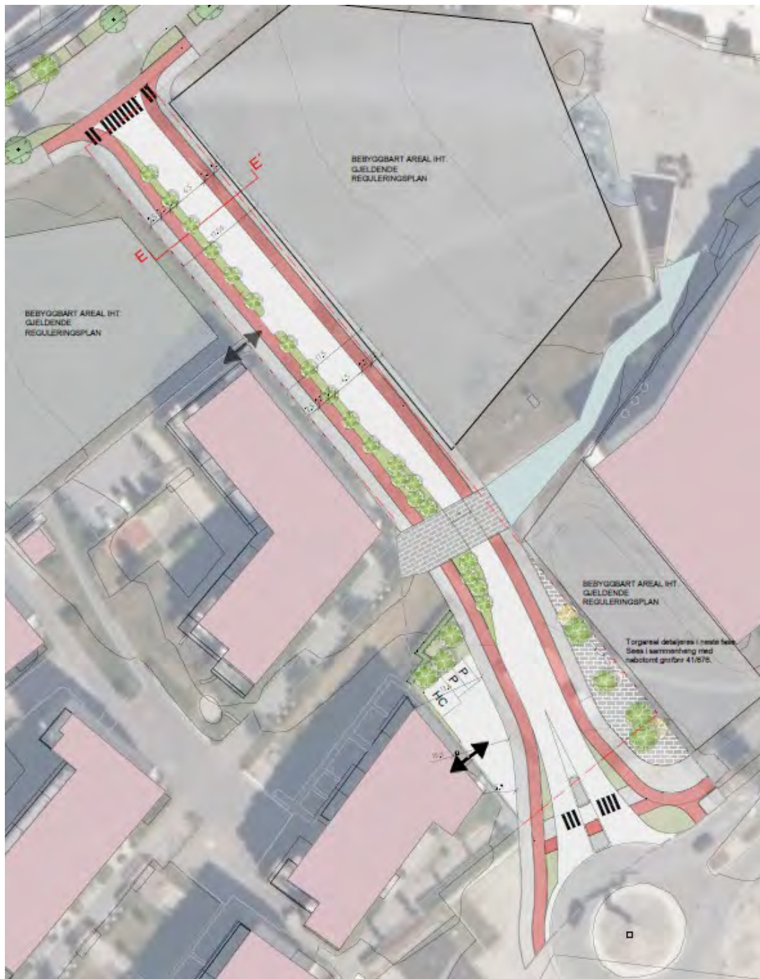
Figur 13. Utsnitt fra landskapsplan for Eva Nansens vei. Grøntrabatt mot boligene, innsnevring av kjørefelt ved krysningspunktet samt opphevet krysningspunkt med annet belegg
