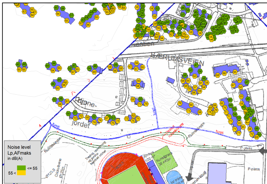
Figur 7: Alt ILTY - Beregnet maksimalt støynivå midt på fasade. Frittfeltverdier.
