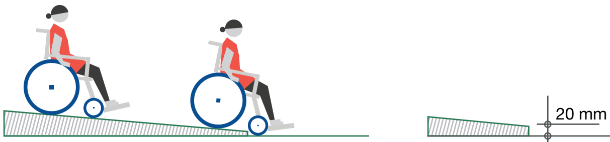
Figur 3-10: Figur viser rampe med nivå sprang, avrundet/avfaset.
